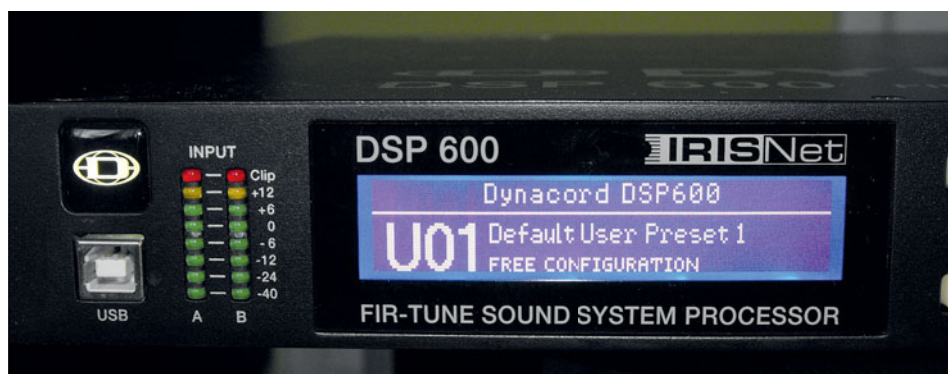
Procesorem można też sterować poprzez gniazdo USB znajdujące się z przodu, po lewej stronie, obok wskaźników sygnałów wejściowych i wyświetlacza LCD.
