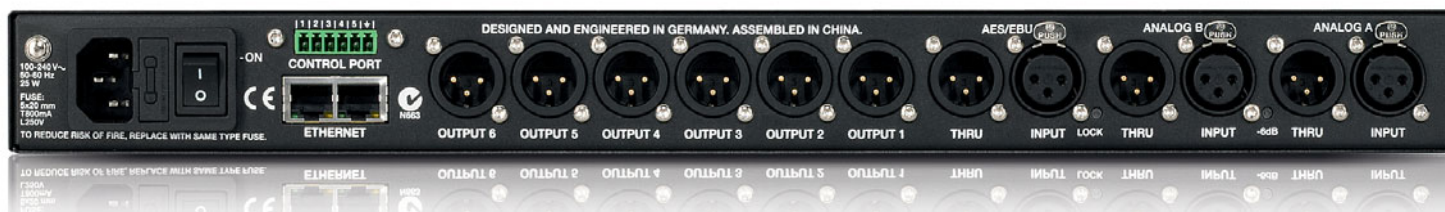
Z tyłu umieszczono wejścia analogowe i cyfrowe oraz wyjścia, a w lewej części terminal służący do zewnętrznego wywoływania pięciu presetów oraz dwa gniazda RJ45 do zarządzania za pośrednictwem sieci Ethernet.
