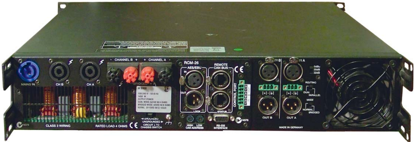
Obok gniazd wyjściowych Speakon (oraz równoległych zacisków śrubowych) zamontowano gniazdo zasilające typu Powercon. Z prawej strony znajdują się gniazda wejściowe (XLR i Phoenix), zaś w środku – opcjonalny moduł RCM-26.
