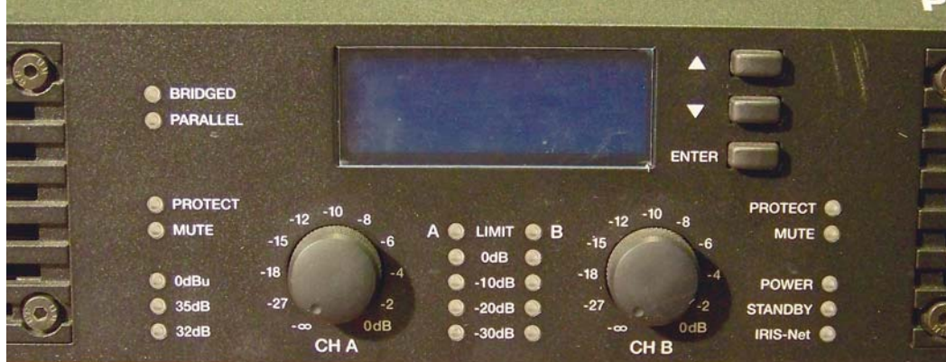
W centrum płyty czołowej znajduje się wyświetlacz LCD, obok którego umieszczono trzy przyciski służące do modyfikacji ustawień menu wzmacniacza. Nie mogło też zabraknąć regulatorów poziomu oraz sporego zestawu kontroltek.
