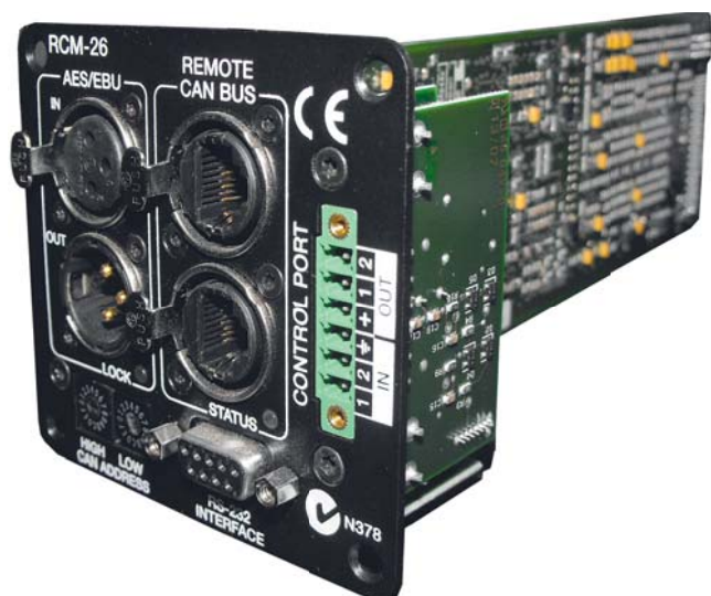
Moduł RCM-26 zawiera dwa procesory DSP 150 MHz, które mogą wykonywać do 300 milionów instrukcji na sekundę.
