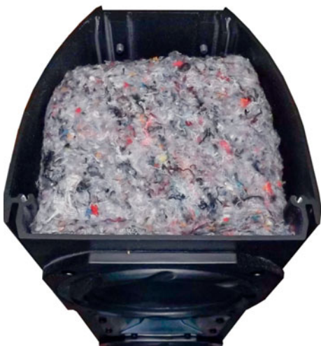
Górna oraz dolna część obudowy zestawu szerokopasmowego dość solidnie zostały wypełnione matą wytłumiającą.
