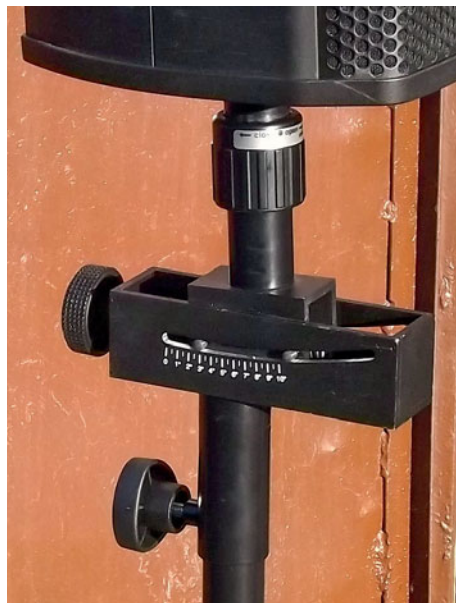
Producent opracował specjalną uchylną głowicę pośrednią TA-TS 400, która pozwala na pochylanie TS 400 – do przodu lub do tyłu (w zależności od zamontowania głowicy) – maksymalnie o 10 stopni.
