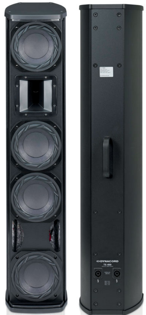
TS 400 wyposażony jest w cztery głośniki o średnicy 6,5” oraz driver współpracujący z tubą o dyspersji 90 × 40 stopni. Na tylnej ścianie zamontowano metalowy uchwyt transportowy, oraz panel, na którym znajdują się dwa gniazda Speakon.
