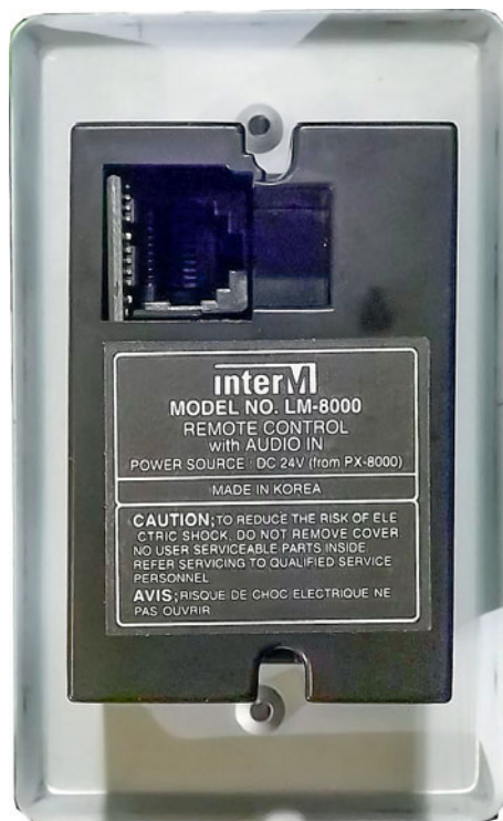
System oparty na matrycy PX-8000 może być wyposażony w naścienny panel sterujący LM-8000 (z własnym wejściem mikrofonowym i liniowym), podłączany do tej matrycy skrętką Cat5, poprzez znajdujące się z tyłu gniazdo RJ45.
