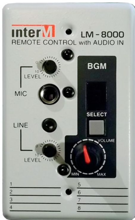
System oparty na matrycy PX-8000 może być wyposażony w naścienny panel sterujący LM-8000 (z własnym wejściem mikrofonowym i liniowym), podłączany do tej matrycy skrętką Cat5, poprzez znajdujące się z tyłu gniazdo RJ45.
