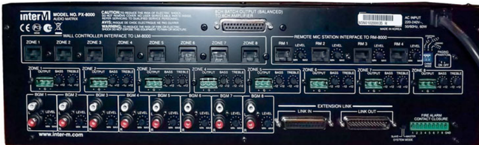
Na tylnej płycie PX-8000 znajdują się wszelkie gniazda wejściowe oraz wyjściowe, jak również część regulatorów nastawianych w zasadzie tylko podczas instalacji urządzenia.
