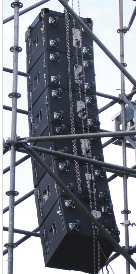
Poszczególne zestawy systemu Cobra są „samowystarczalne” – po zdemontowaniu z wieży zakłada się pokrywę chroniącą głośniki i „odjeżdża” do ciężarówki.
