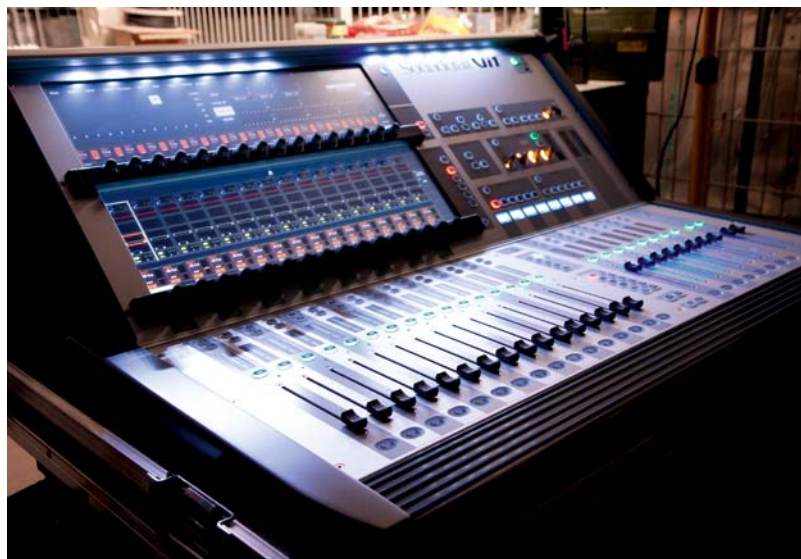
Główna konsola FOH to Vi6 Soundcrafta, usytuowana w kabinie akustyka (z lewej), zaś jako mikser monitorowy pracuje konsola typu „stand alone” Vi1, również firmy Soundcraft.
