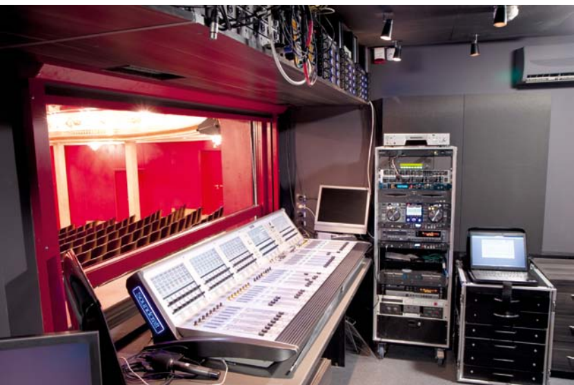
Główna konsola FOH to Vi6 Soundcrafta, usytuowana w kabinie akustyka (z lewej), zaś jako mikser monitorowy pracuje konsola typu „stand alone” Vi1, również firmy Soundcraft.
