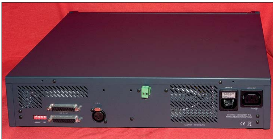
Jedynym wejściem dla analogowego sygnału audio jest umieszczone z tyłu symetryczne wejście w postaci gniazda XLR.
