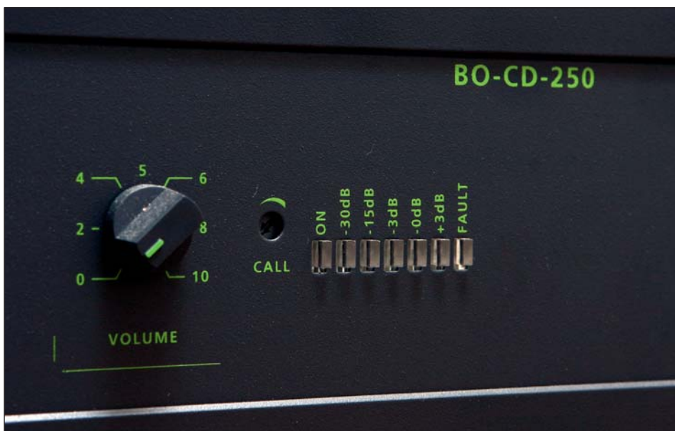
Na panelu czołowym, obok regulatorów głośności, zgaduje się kolekcja diod LED, sygnalizujących stan urządzenia i poziom wysterowania sygnału wyjściowego.
