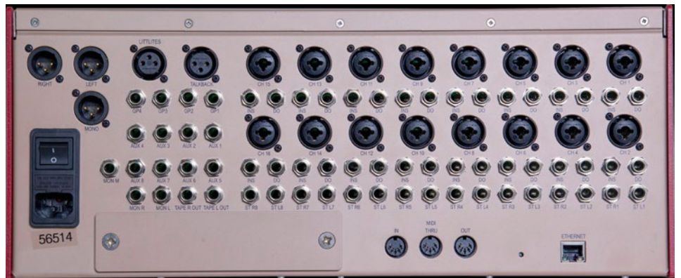
Na CDC four:m znajduje się 16 mikrofonowo-liniowych kanałów mono (każde z własnym insertem i wyjściem Direct), 8 wejść stereo, 4 podgrupy oraz 8 wyjść pomocniczych AUX.
