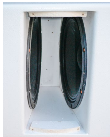
Przetworniki zastosowane w V2-212S to konstrukcje Community o średnicy 12 cali, wyposażone w system chłodzenia Cool-Coil.
