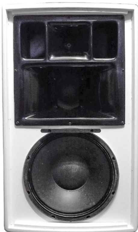
Trójdrożny pasywny zestaw głośnikowy V2-3294 jest największym z testowanych urządzeń.
