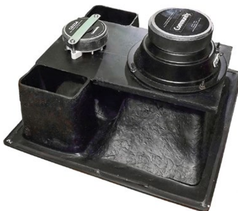
Głośniki średnio- oraz wysokotonowy V2-3294 zamontowane zostały na wspólnym podwójnym hornie, w obudowie którego wykonane zostały również otwory bass-reflex, umieszczone po obu stronach drivera.
