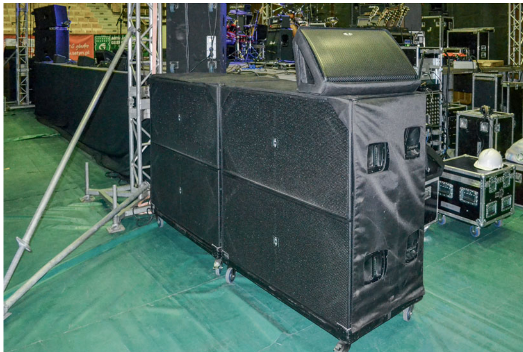
System Cobra wspomagało w sumie 8 subbasów Sub 28 – po 4 na stronę – na których ustawiono po jednym monitorze CXM 15 jako outfill.
