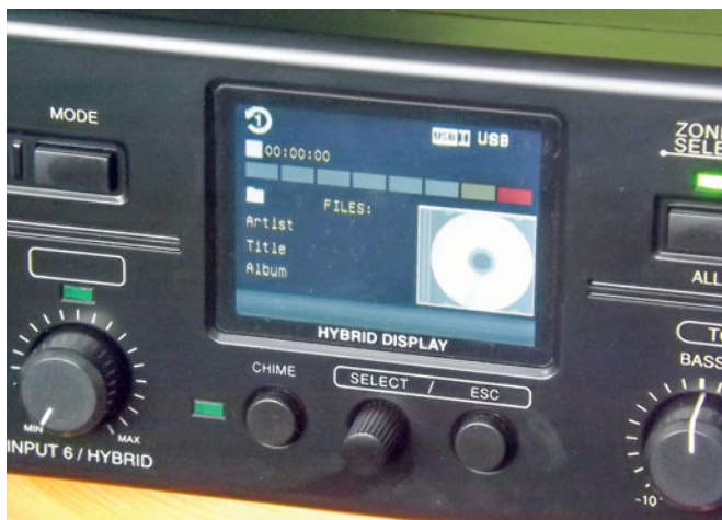
W centralnym miejscu przedniego panelu zamontowano niewielki graficzny, kolorowy wyświetlacz LCD do obsługi całego miksera oraz odtwarzacza multimedialnego.
