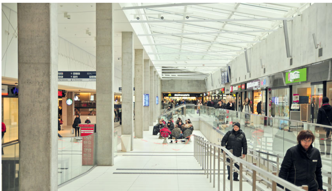
Hala główna dworca w Katowicach to pomieszczenie o bardzo dużej kubaturze, którą wypełniają kamienne podłogi, wysokie betonowe kielichy i dwie kilkunastometrowe ściany ze szkła – słowem „akustyczny koszmar”.
