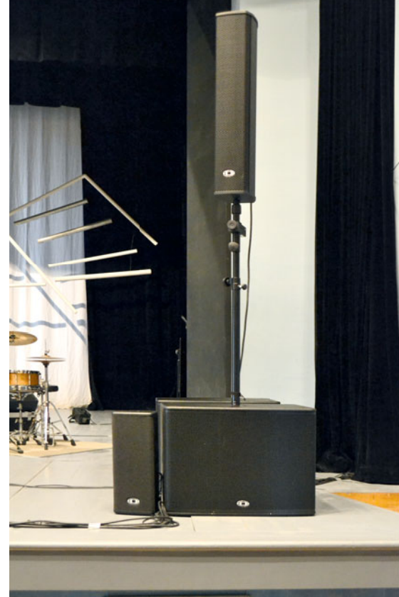
Nagłośnienie stanowiły dwa subbasy Dynacorda (PSD218/PSE218) plus zestaw szerokopasmowy TS400 na stronę, wspomaganie parą VL262 pracujących jako frontfil (infill).
