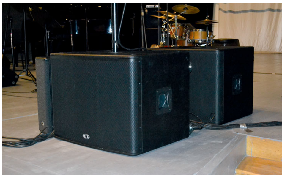
Subwoofery pracowały w konfiguracji „end fired”, dzięki czemu emisja niskich częstotliwości w kierunku sceny była ograniczona.
