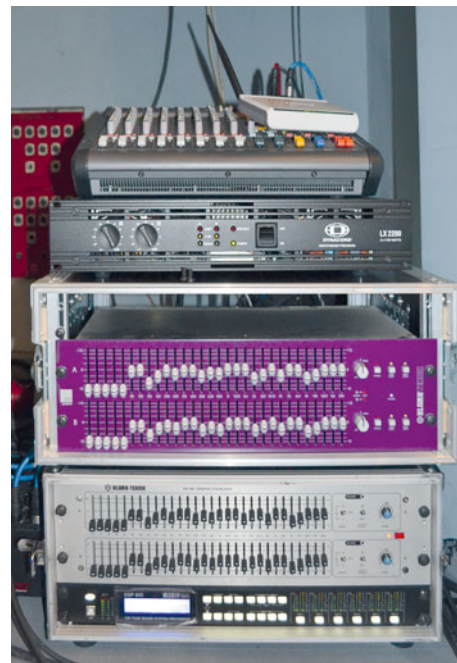
Subwoofery pasywne były napędzane ze wzmacniacza Dynacord LX 2200, zaś odpowiednie „rozsynchronizowanie czasowe” oraz odfiltrowanie w crossoverze sygnałów zapewniał procesor DSP 600 (na dole raka).
