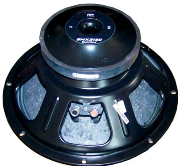
Za pracę C 12.2 odpowiadają dwa przetworniki firmy Electro-Voice – 12-calowy woofer SMX2120 oraz driver DH2010 o średnicy wylotu 1,25”, współpracujący z tubą o niesymetrycznej dyspersji.
