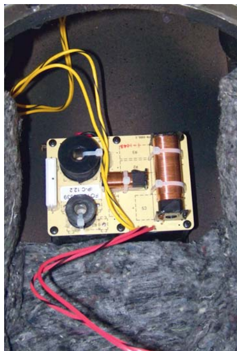
Wewnątrz obudowy zamontowano prosty filtr dzielący pasmo na poszczególne głośniki.
