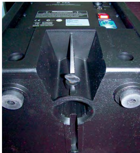
...które znajdują się w dolnej ścianie, gdzie również znajdziemy gniazdo statywu, wraz ze śrubą zabezpieczającą.
