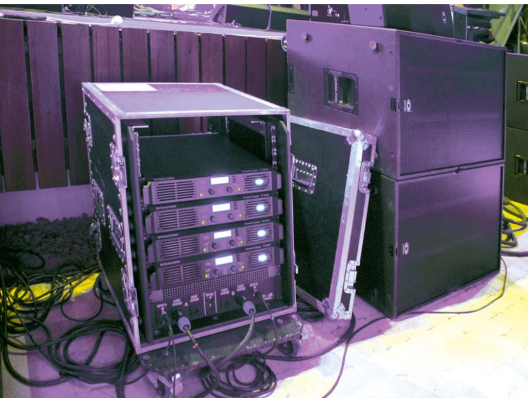
Obydwa systemy – FOH i monitorowy – napędzają wzmacniacze Dynacorda z rodziny PowerH.
