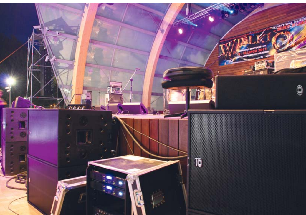
Do nagłośnienia amfiteatralnej trybuny zastosowano system Dynacord Cobra 4 w konfiguracji: 12 szt. Dynacord COBRA – 4 TOP podwieszono w dwóch klastrach i 16 subbasów Dynacord COBRA – PWH.
