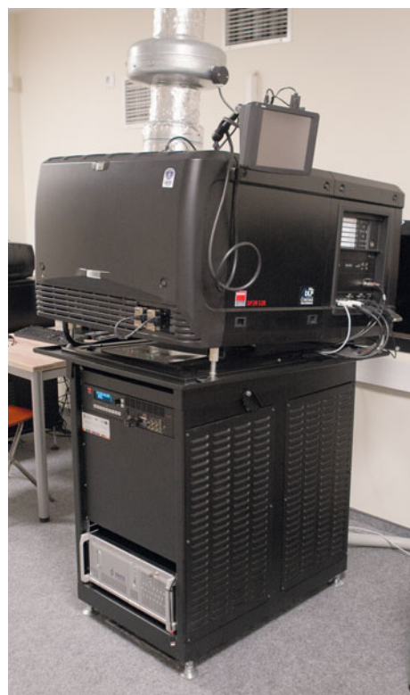
Jeden z dwóch nowych projektorów 3D – Barco DP2K-32B – który pozwala na wyświetlanie filmów w postaci kodowanej.
