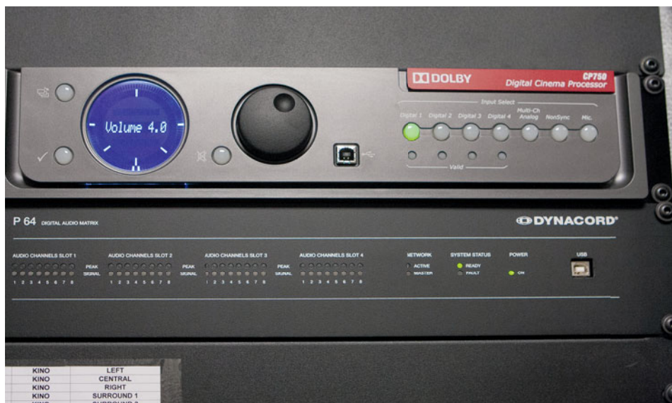
...oraz – na samej górze – procesor cyfrowy systemu kinowego Dolby CP750 i matrycę Dynacord P 64.
